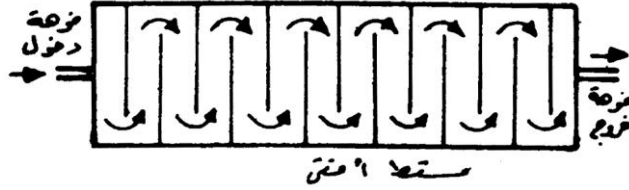
الشكل (3-5): نموذجين لأحواض تشكيل الندف ذات الحواجز
